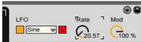
Au début de la piste H, la fréquence du LFO est encore trop faible pour être entendue. Cependant, à mesure que vous augmentez le taux, elle enveloppera la gamme lancée, ayant pour résultat l'équivalent d'ajouter un autre oscillateur ! En outre, la quantité de mod agira maintenant essentiellement en tant que commande de volume de cet oscillateur fantôme, et évalué en tant que commande de lancement.
