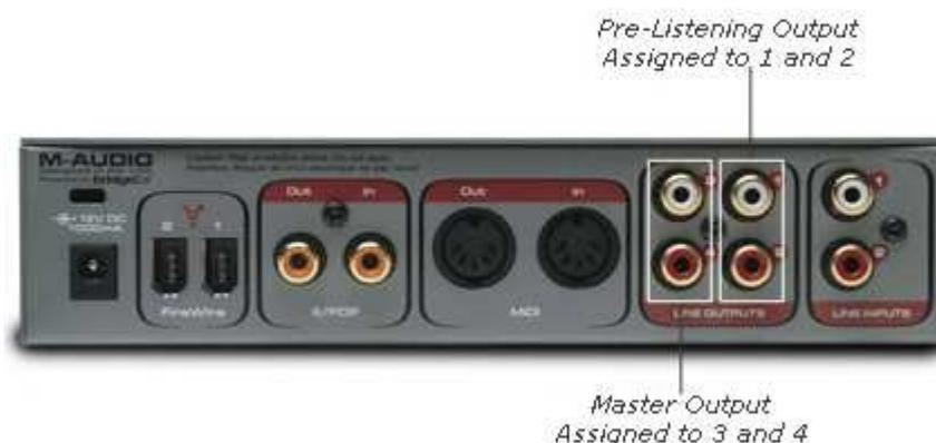
L'interface audio FireWire M-Audio d'Audiophile a été employée pour ce cours d'instruction, toutefois n'importe quelle interface audio avec assez de sorties fonctionnera. La sortie Pré-Écoute est placé dans les préférences audio de Live, dans la section de sortie, suivant les indications de la figure ci-dessous.
