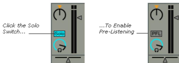
Dans les pistes de l'écran de session, une icône d'écouteur apparaîtra au lieu du bouton solo (montré au-dessous à droite). C'est le bouton de Pré-Écoute et, une fois activé, conduit une piste à la sortie de Pré-Écoute. Le bouton avec l'icône de haut-parleur (le bouton d'activateur de piste) au-dessus du bouton de Pré-Écoute conduit la piste à la sortie Master (montré au-dessous à gauche).
